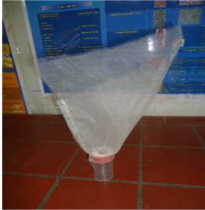
Figure 11 : photo originale du filet planctonique muni d'un pilulier.
