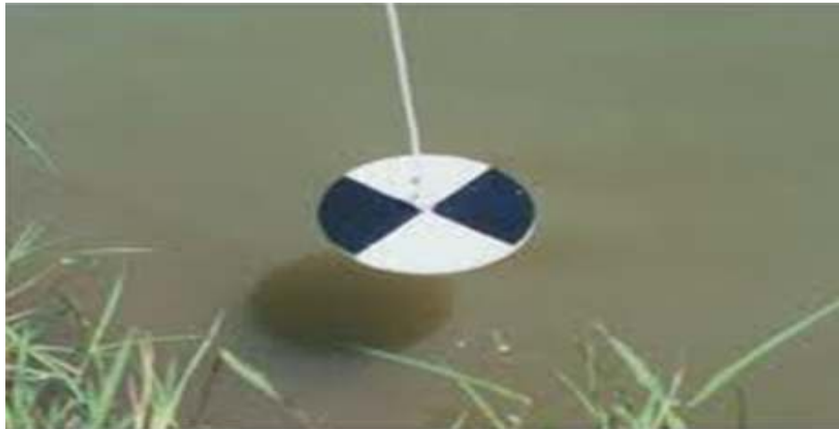
Figure 10 : photo originale du disque de Secchi muni d'une corde graduée.
