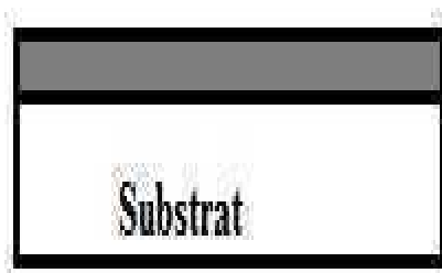
Figure 3.8. Dépôt de 05 couches avec refusion par la torche Eutalloy et Réalisé par la poudre chrome tec, Refroidissement par (air et eau).
