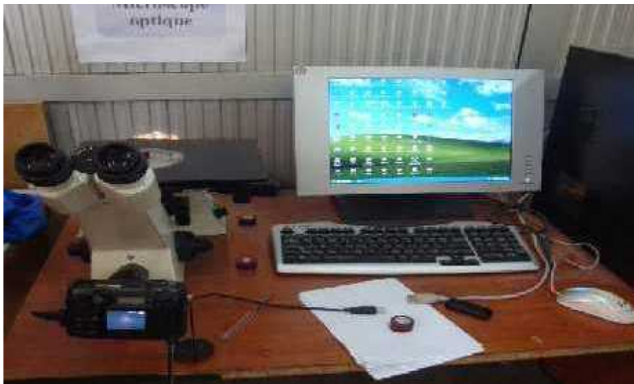
Figure 3.17. Microscope optique utilisé pour l'analyse métallographique.
