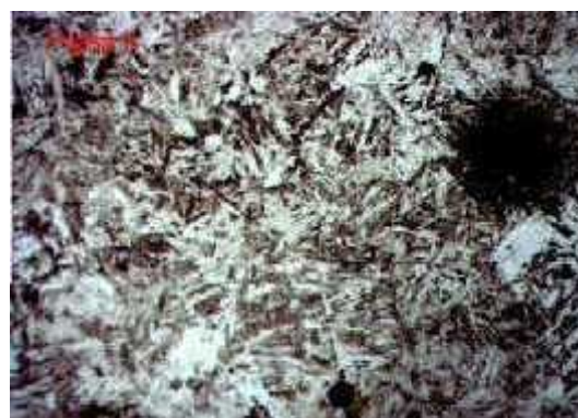
Figure 3.2. Microstructure initiale de l'acier 42CrMO4 [26].
