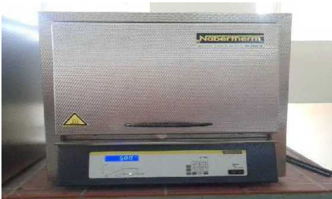
Figure 3.11. Le four utilisé pour le traitement de mise en solution.
