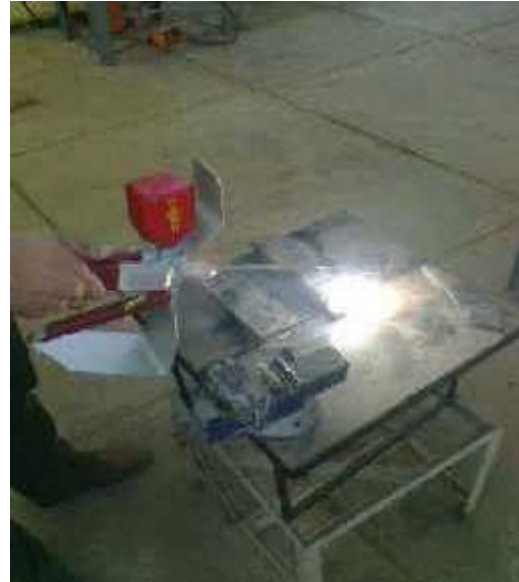
Figure 3.7. La projection par le Pistolet Eutalloy (super Jet-S).
