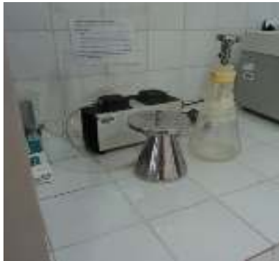
Dispositif de filtration sous vide
