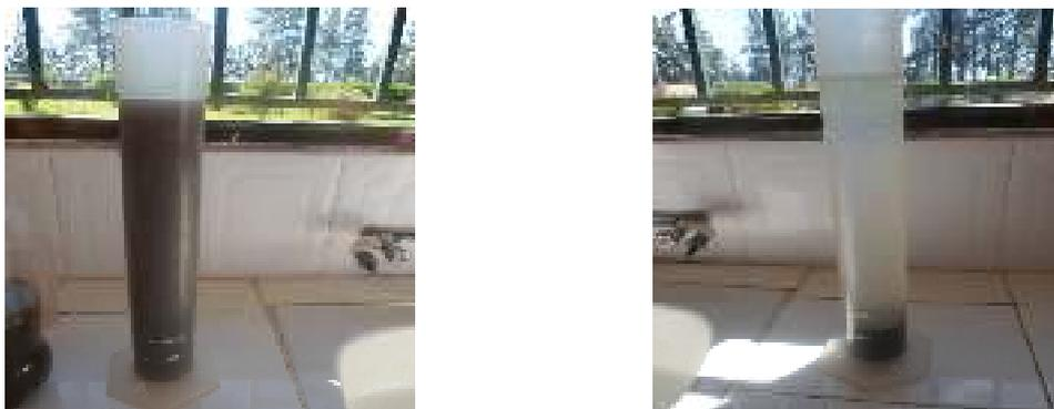
**Fig. 40 : Test de décantation des boues de bassin d'aération (photos originales)**
