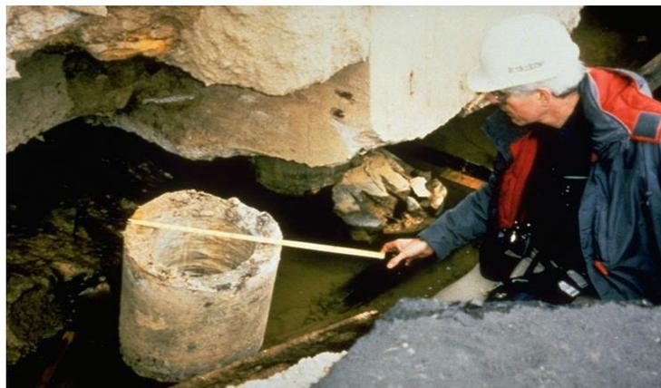
Figure 1.15: Cisaillement du pieu après le séisme de Kobe en Japon, 17 Janvier 1995
