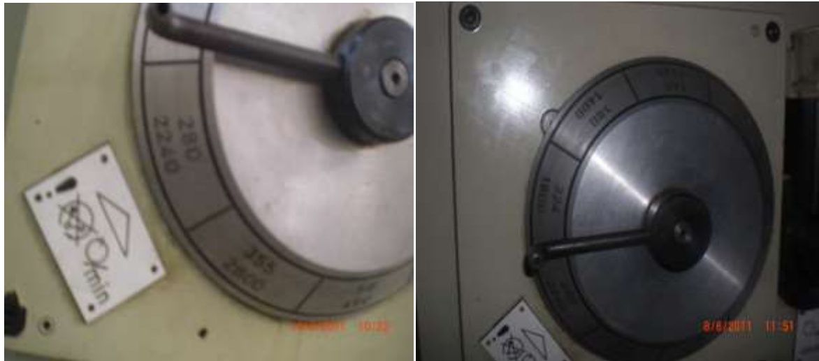
Figure III.6 Régler la vitesse de rotation de l'outil ( V_r )
