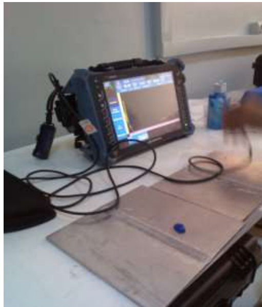
Figure III.19 Contrôle par ultrason des plaques soudées
