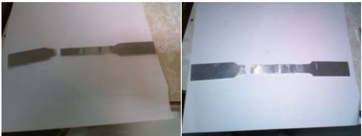
Figure 4.20 : Eprouvettes non traitée ayant subies l'essai de traction pour un épaisseur de 3 mm
