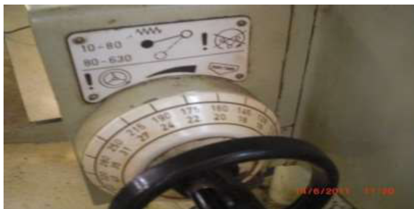
Figure III.7 Régler la vitesse d'avance de soudage ( V_a ) l'angle d'inclinaison \alpha .
