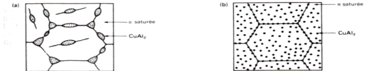
Figure I.6 microstructure obtenues à l'ambiante dans un alliage AL-4%Cu
