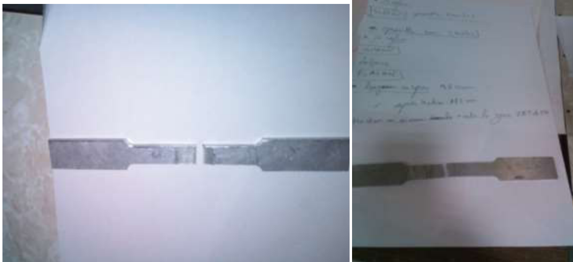
Figure 4.22 : Eprouvettes traitées ayant subies l'essai de traction pour un épaisseur de 3 mm
