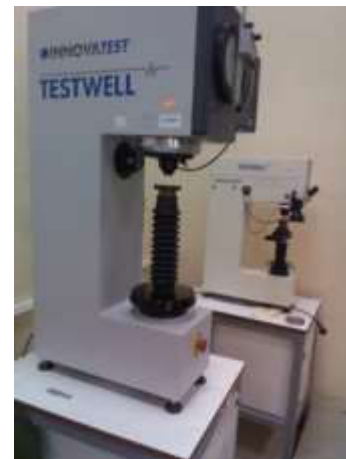
Figure III.37:D'uroètre utilisé pour mesurer la dureté
