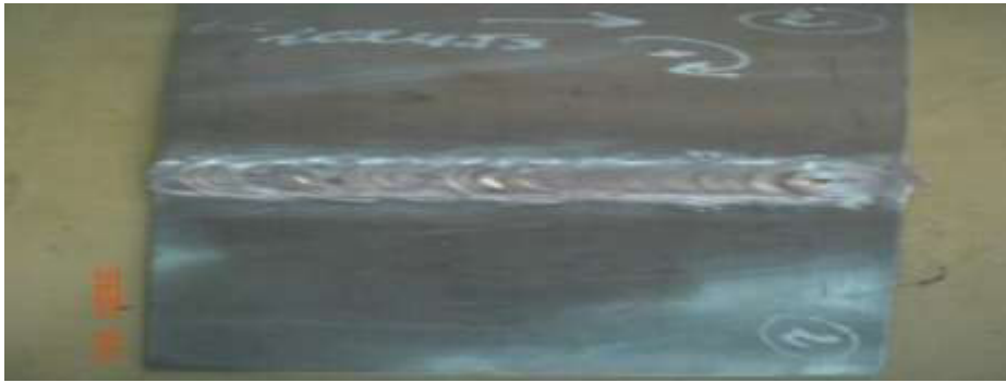
Figure III.15 Soudage de la tôle 2024-T3 ( e = 2 \text{ mm} ), V_r = 1125 \text{ tr/min} , V_a = 60 \text{ mm/min} , \alpha = 1^\circ a) face avant et b) faces arrière
