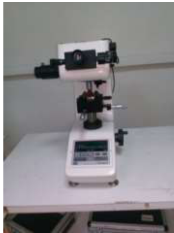
Figure III.36:D'uroètre utilisé pour mesurer la micro dureté
