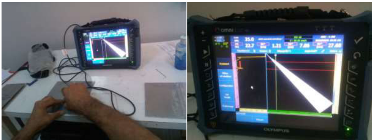
Figure 4.9 : contrôle par ultrason des plaques soudées
