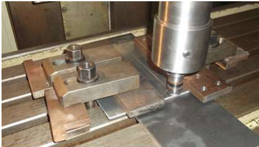
Figure III.9 Système de bridage pour la fixation des tôles
