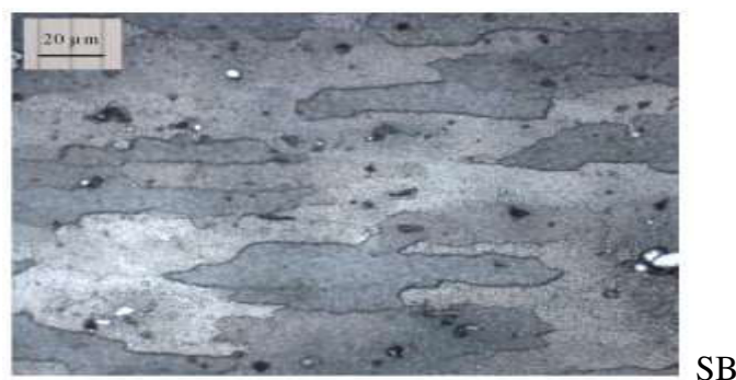
Figure I.12 Grains observés au microscope optique pour un grossissement de 500 sur la face 1 [12]
