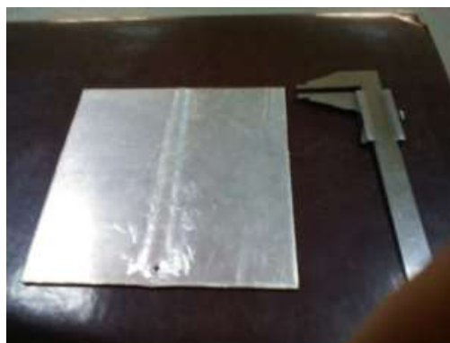
Figure III.17 Soudage de la tôle 2024-T3 ( e = 5 \text{ mm} ) V_r = 1625 \text{ tr/min} , V_a = 36 \text{ mm/min} et \alpha = 1^\circ
