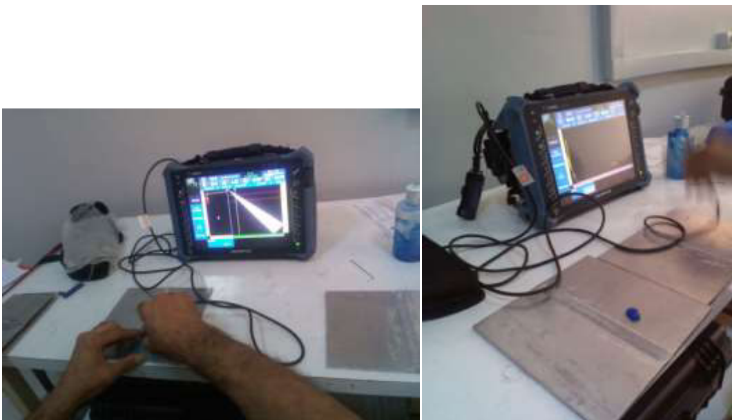
Figure III.20 : Contrôle par ultrason des plaques soudées
