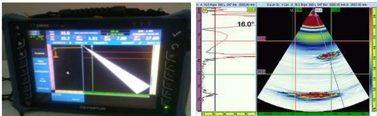
Figure III.21 principe de contrôle par ultrason des plaques soudées
