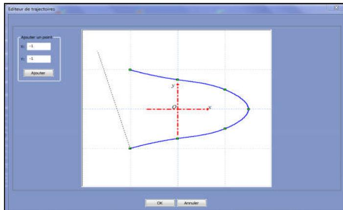
Figure IV-21: La courbe résultante après calcul des splines cubiques
