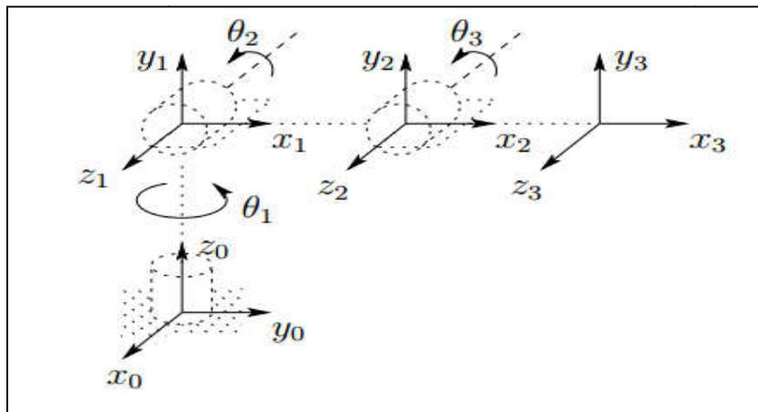
Figure II-3: Repères attachés aux corps d'un manipulateur
