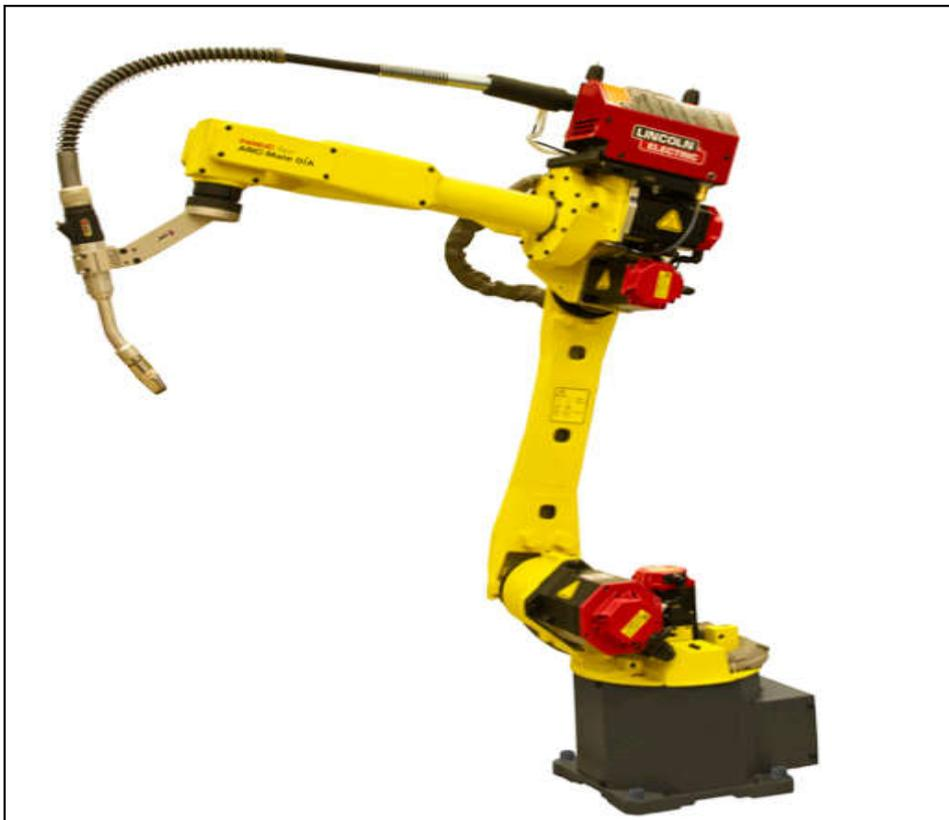
*Figure IV-1: Manipulateur de soudage*
