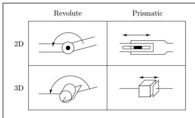
*Figure I-2: Schématisation des joints rotoïdes et prismatiques*
