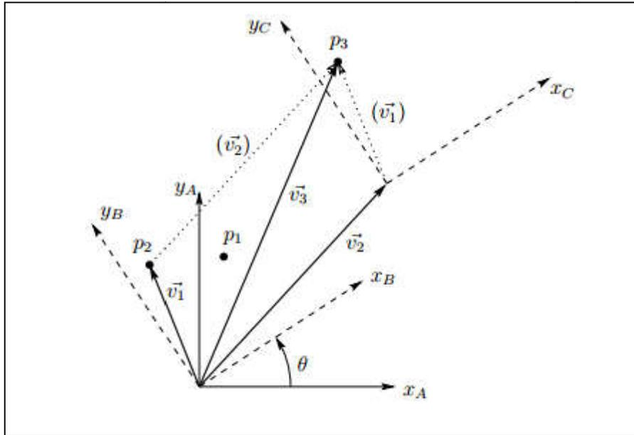
Figure II-1 : Transformation homogène en deux dimensions
