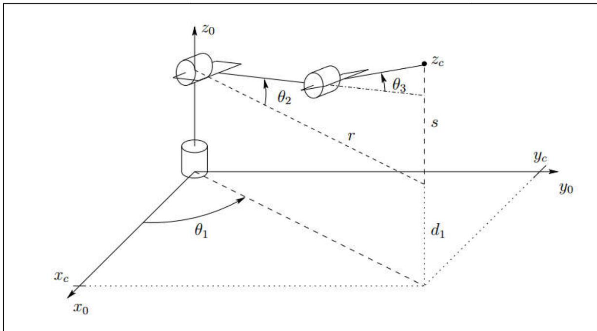
*Figure IV-5: Représentation du manipulateur de la base jusqu'au poignet*
