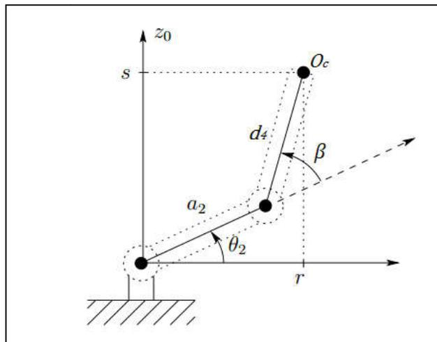
*Figure IV-7: Projection sur le plan formé par le deuxième et le troisième corps*
