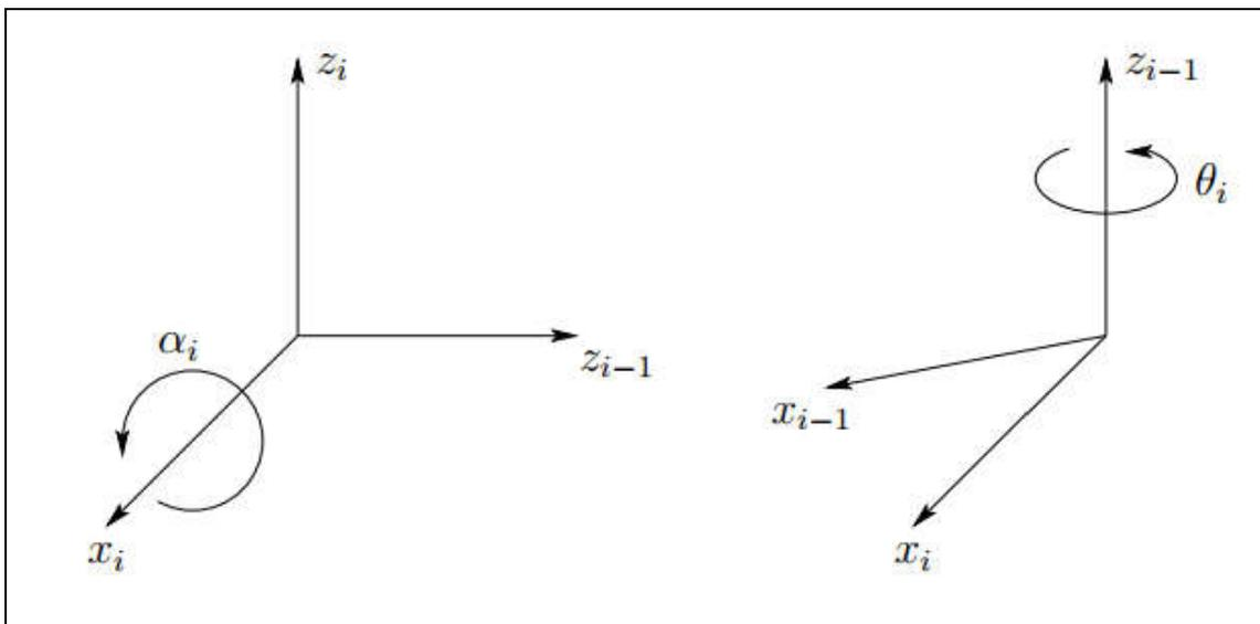
Figure II-5: Sens positif pour  $\alpha_i$  et  $\theta_i$
