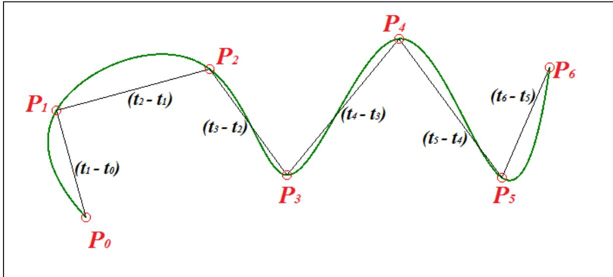
Figure III-3: Spline cubique paramétrée
