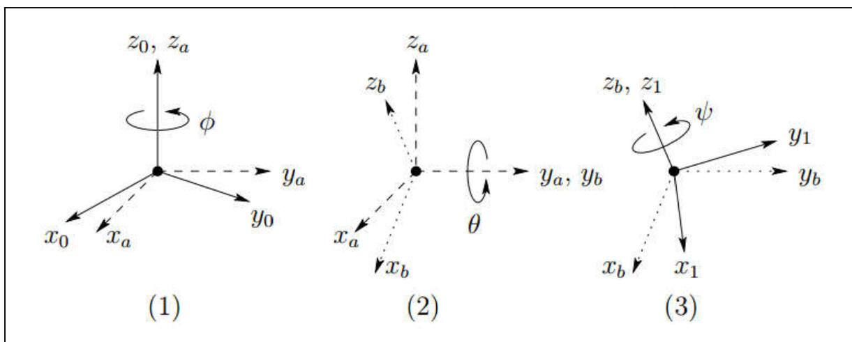
On peut spécifier l'orientation du repère  $R_1(o_1x_1y_1z_1)$  par rapport au repère  $R_0(o_0x_0y_0z_0)$  par trois angles  $(\phi, \theta, \psi)$ , connus sous le nom d'angles d'Euler et obtenus par trois rotations successives, comme suit :
