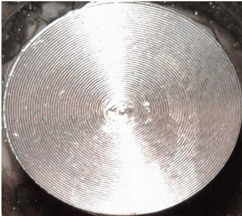
**Figure IV.4:** Image réelle de la surface usinée ;  $re = 0.4$  mm,  $f = 0.4$  mm/tr
