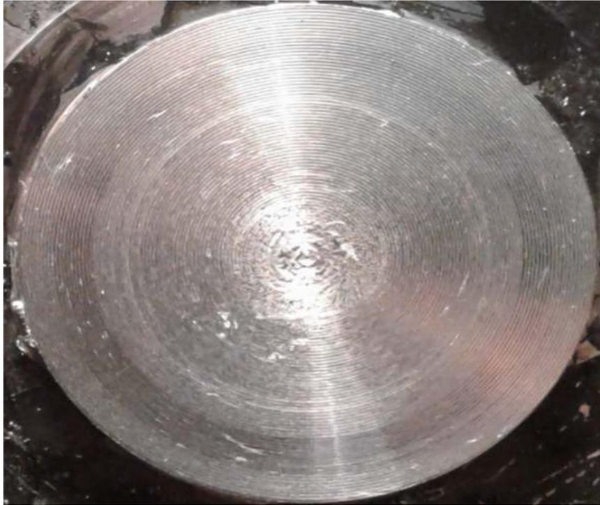
**Figure IV.6:** Image réelle de la surface usinée ;  $r_e = 0.8$  mm,  $f = 0.2$  mm/tr
