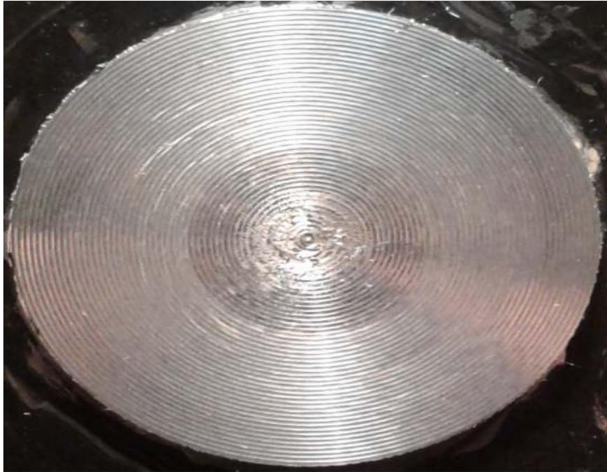
**Figure IV.8:** Image réelle de la surface usinée ;  $r_e = 0.8$  mm,  $f = 0.4$  mm/tr
