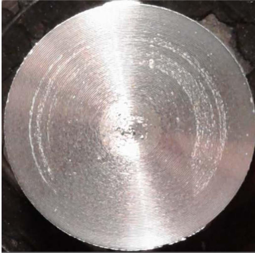
**Figure IV.2:** Image réelle de la surface usinée ;  $re = 0.4$  mm,  $f = 0.2$  mm/tr
