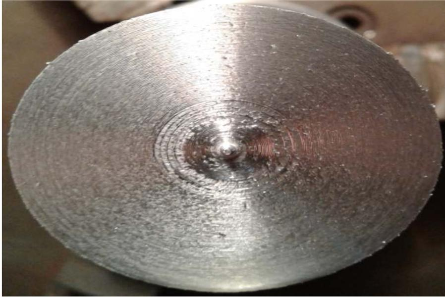
**Figure IV.16:** Image réelle de la surface usinée ;  $re = 0.8 \text{ mm}$ ,  $f = 0.4 \text{ mm/tr}$
