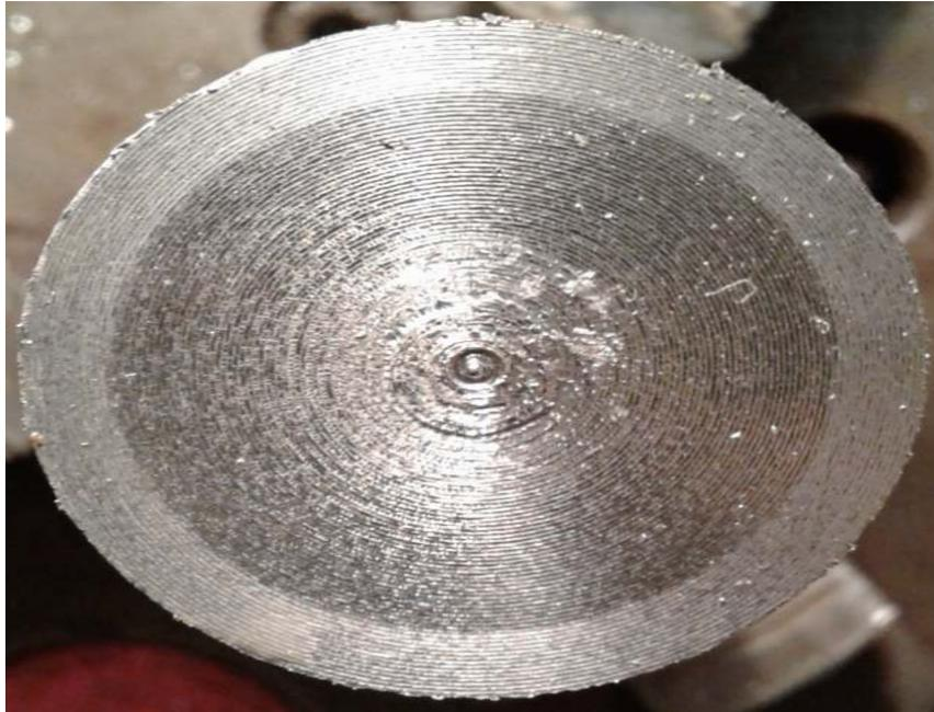
**Figure IV.10:** Image réelle de la surface usinée ;  $re = 0.4 \text{ mm}$ ,  $f = 0.2 \text{ mm/tr}$
