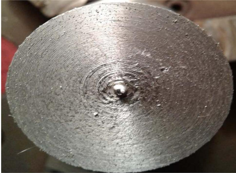
**Figure IV.14:** Image réelle de la surface usinée ;  $re = 0.8 \text{ mm}$ ,  $f = 0.2 \text{ mm/tr}$
