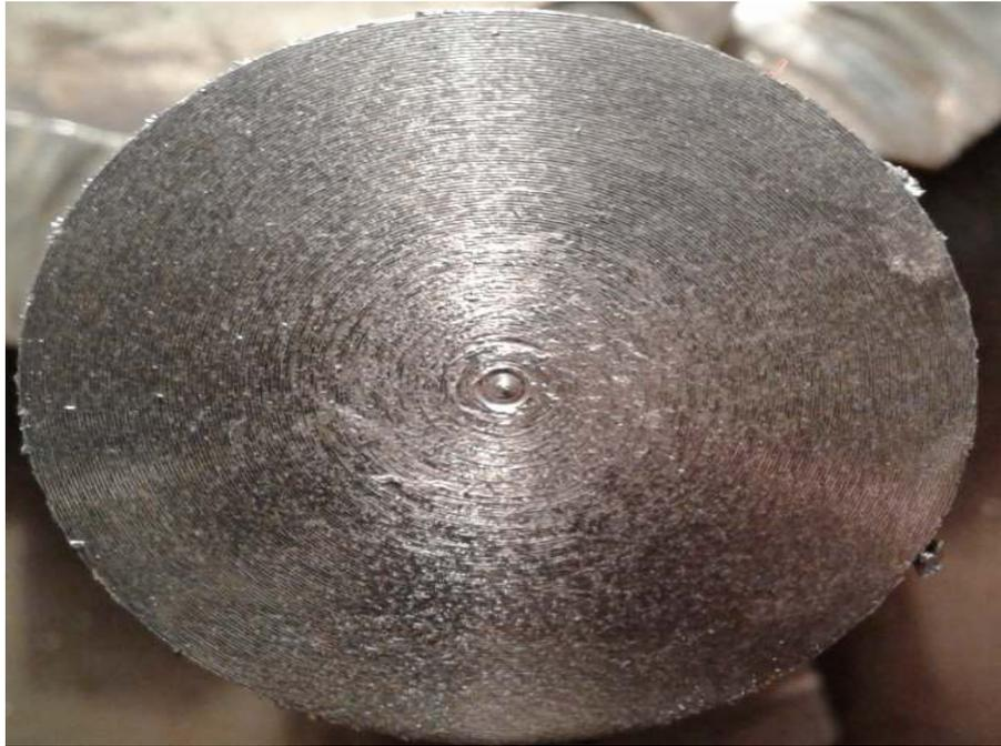
**Figure IV.12:** Image réelle de la surface usinée ;  $re = 0.4$  mm,  $f = 0.4$  mm/tr
