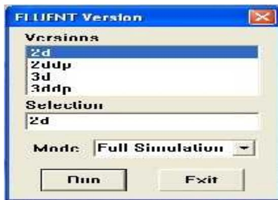
**Figure (V.4) : Le choix du plan et de type de précision.**
