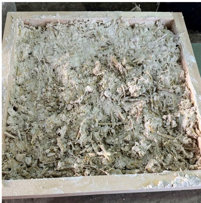
*Figure 20: Echantillon raté dû à un rapport d'eau inadéquat*
