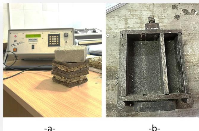
*Figure 26:-a- : Essais à l'aide de CT-METRE -b- : Les moules utilisés*
