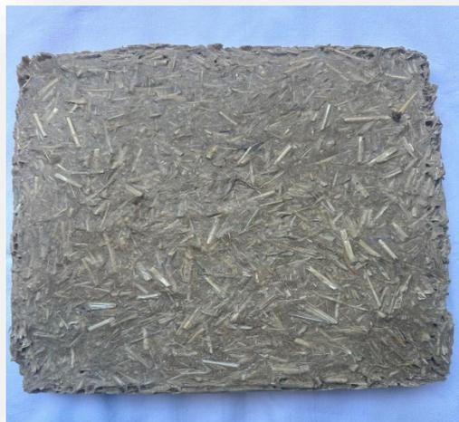
**Figure 23:** Echantillon de la configuration 03 Paille-Amidon
