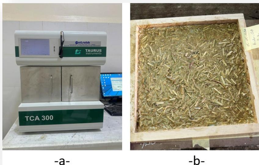
*Figure 27: -a- : Le FLUXMETRE -b- : Les moules utilisés*
