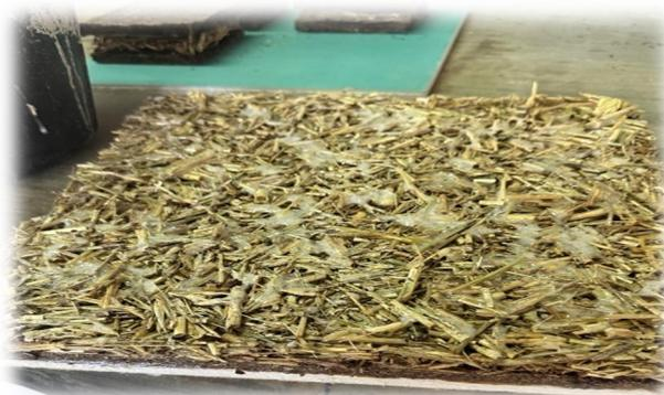
*Figure 24: Assemblage du panneau*
