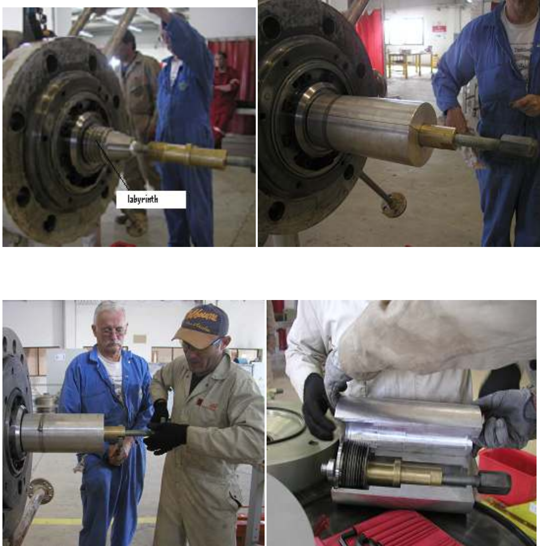
Figure IV.4: Extraction de la garniture d'étanchéité de l'arbre.
