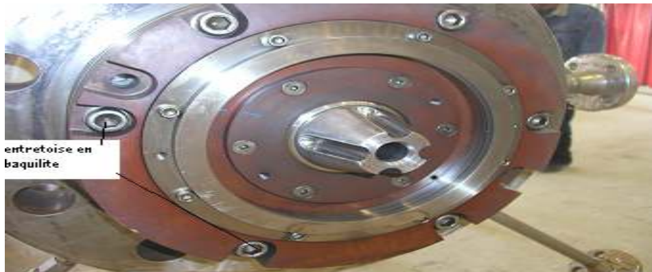
Figure IV.2: Démontage de l'entretoise Cote expandeur .
