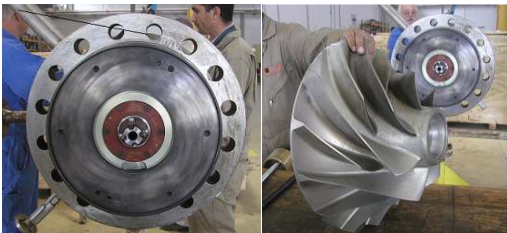
Figure IV.1: Démontage des roues.
