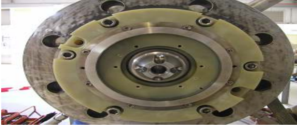
Figure IV.15: Montage du mur de chaleur cote expandeur.
