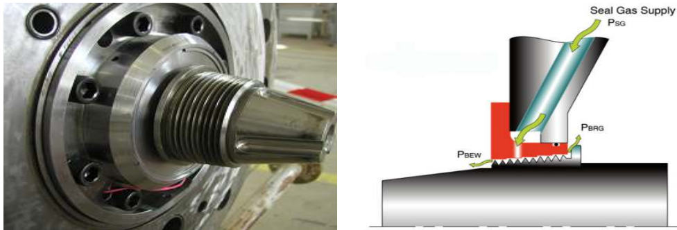
Figure 11-6 :le labyrinthe de l'arbre sur les deux cotés (expandeur –compresseur).
