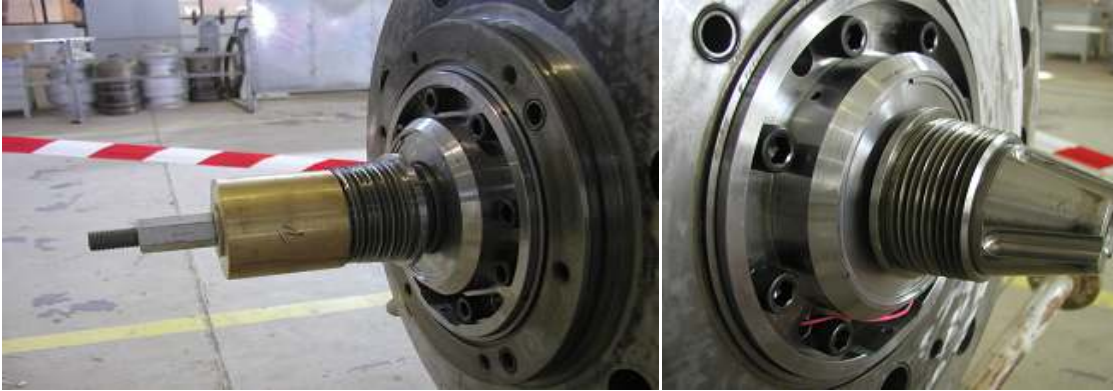
Figure IV.13: Installation de la garniture d'étanchéité de l'arbre.
