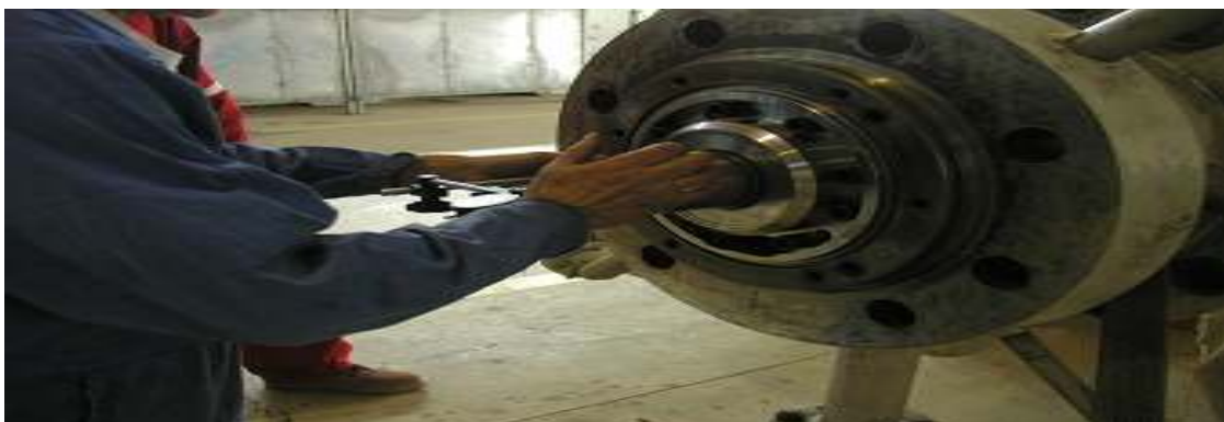
Figure IV.12: Vérification du jeu axial.
