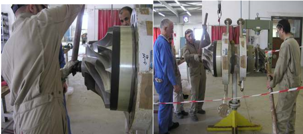
Figure IV.19: Serrage de la tige de tension.
