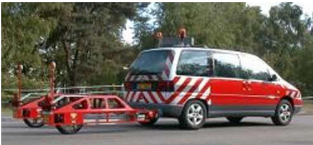
Figure 3.5: Analyseur de profil en long
