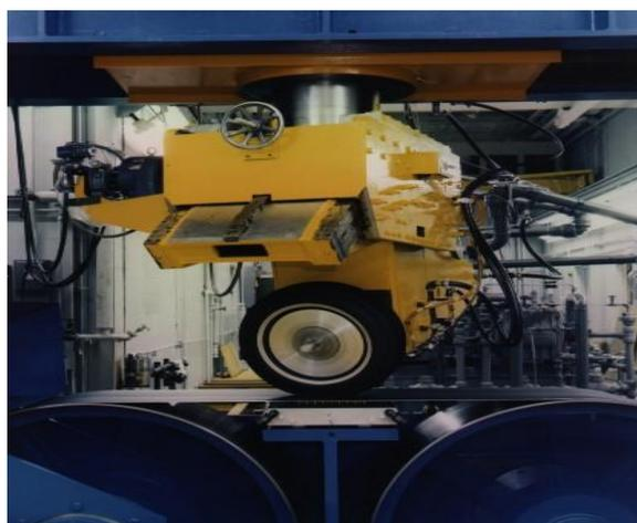
Figure 1.9 : banc de caractérisation de pneumatique « MTS flatrac »
