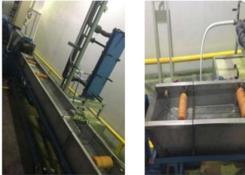
Figure III-17: Exemple de la partie de refroidissement
