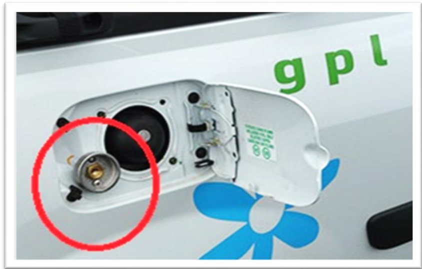
Figure 4 : emplacement du dispositif de remplissage
