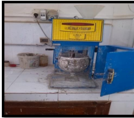
Figure II.5. Malaxeur automatique de type Perrier.
