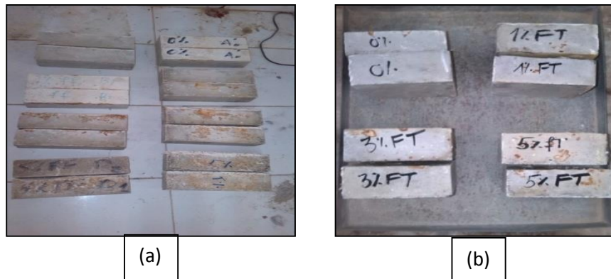
Figure II.7. (a) Eprouvettes pour essais mécaniques (40 mm × 40 mm × 160 mm) Eprouvettes pour essais thermiques (100 mm × 100 mm × 50 mm)
