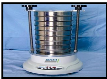
Figure II.2: Appareil de tamisage du bois de palmier dattier.[1]
