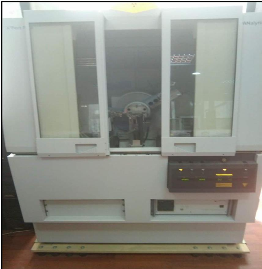
**Figure III.9** : Un diffractomètre des Rayons X de Type PANalytical (X'Pert3 Powder).
