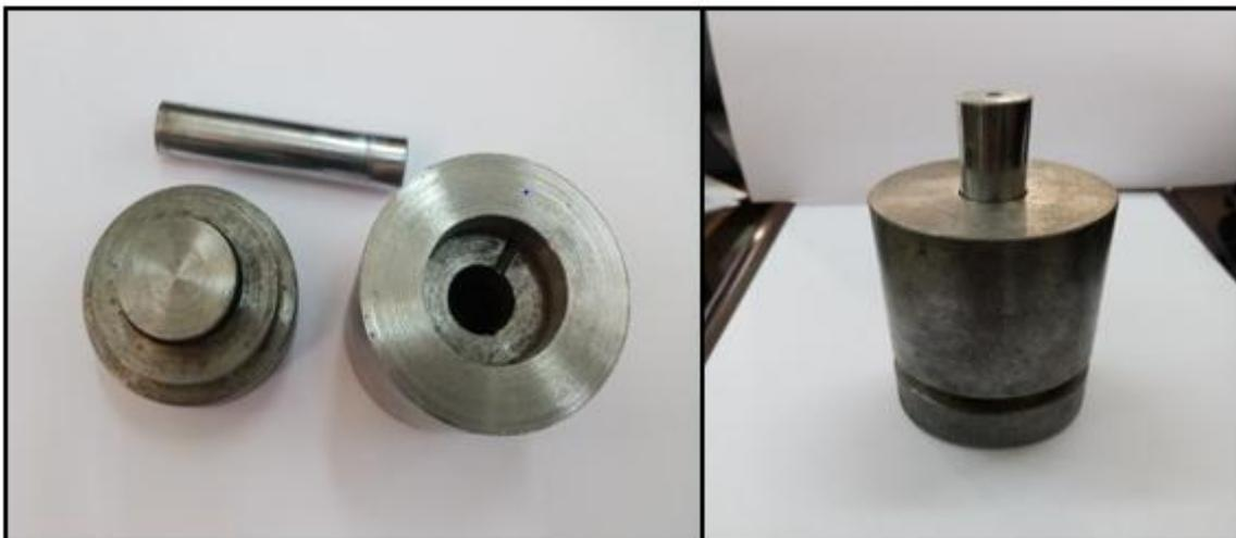
**Figure III.3** : Dispositif de compactage des poudres.
