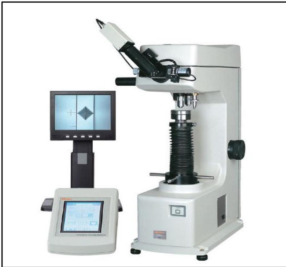
**Figure III.12** : Duromètre de type Vickers, INOVATEST Nemsis 3000.
