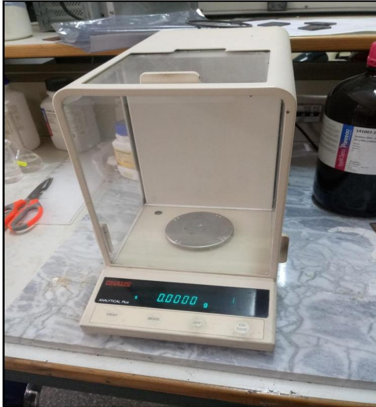
**Figure III.2** : Balance de précision ( $10^{-4}$ g).
