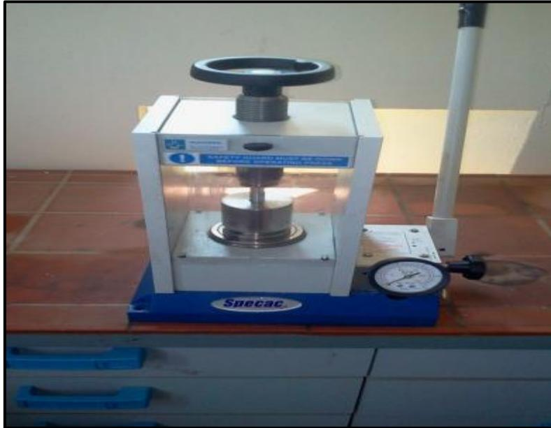
**Figure III.4:** Presse hydraulique uniaxiale de type SPECAC.
