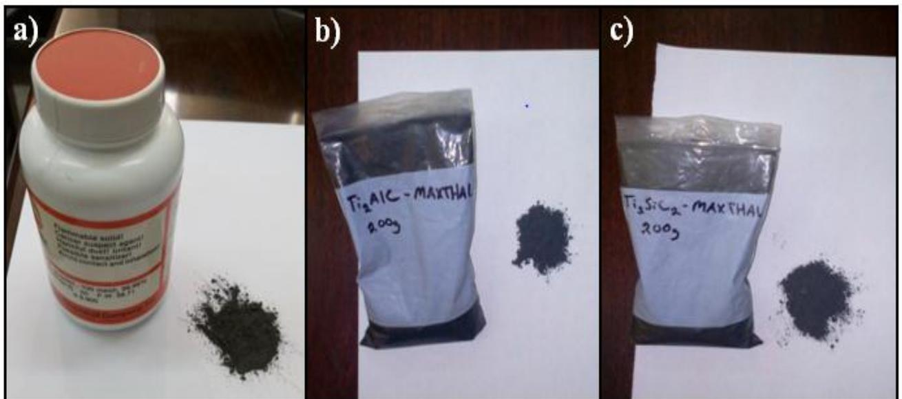
Figure III.1 : Poudres de : a) Nickel pure, b)  $\text{Ti}_2\text{AlC}$ , c)  $\text{Ti}_3\text{SiC}_2$ .
