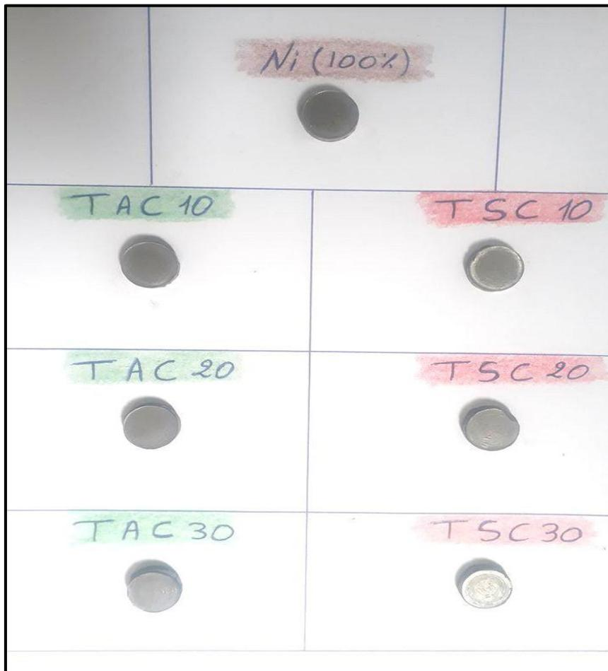
**Figure III.5 :** Pastilles cylindriques obtenues par compactage.
