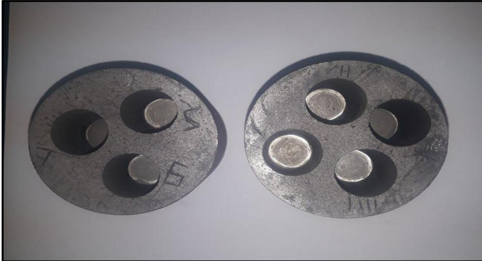
Figure III.6 : Porte échantillons en graphite.
