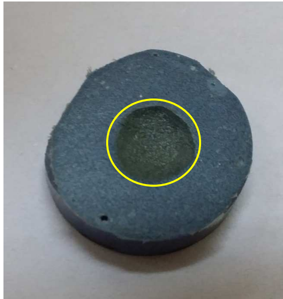
Figure IV.56 : capillarité réduite pour 210°C
