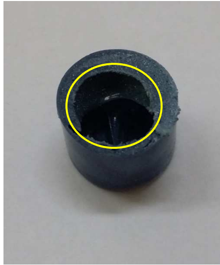
Figure IV.50 : capillarité importante à 185°C
