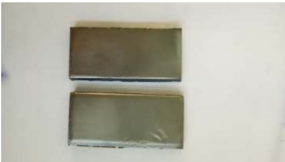
Figure 30 : Aspect surfacique des revêtements par flamme-poudre
