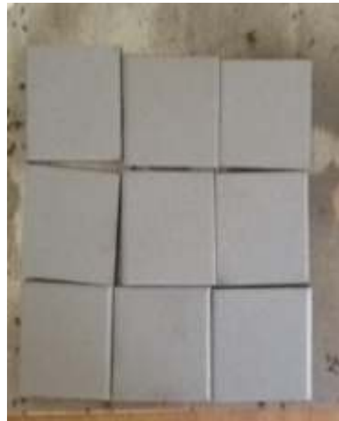
Figure 21 : Aspect des tôles après sablage
