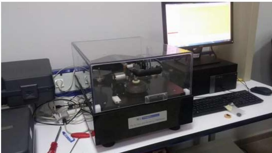
**Figure III. 21** : Tribomètre rotatif.
