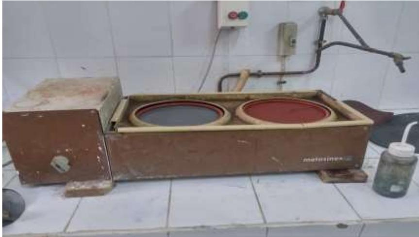
**Figure III. 13** :polisseuse double plateau.
