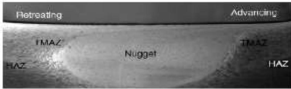
**Figure II. 8 :** *Microstructure des différentes zones dans un joint pendant le FSP.[II-3]*
