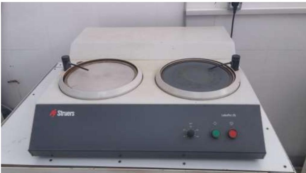
**Figure III. 14** :polisseuse double plateau.
