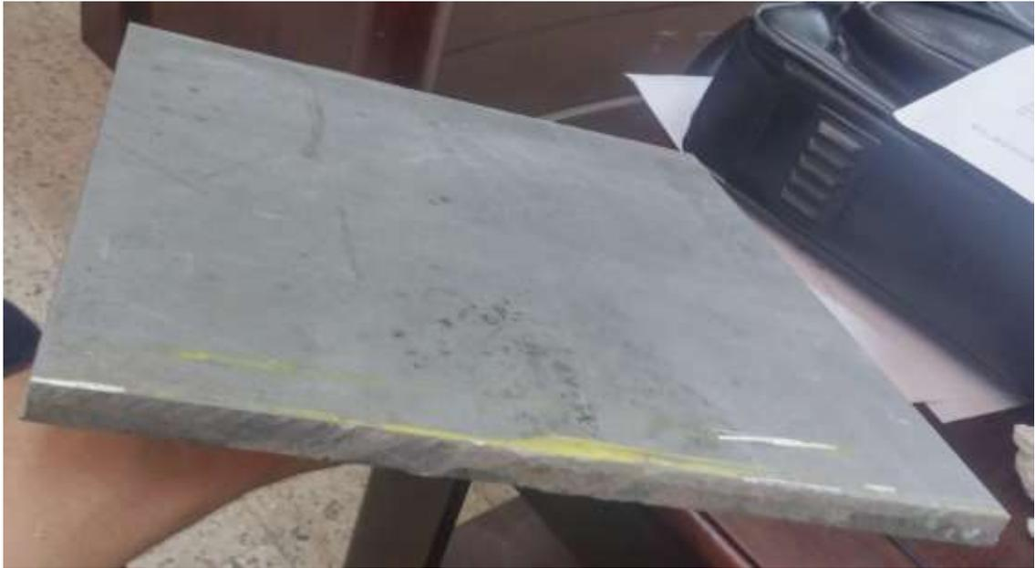
**Figure III. 1 :** tôle d'alliage d'aluminium 2024 T3.
