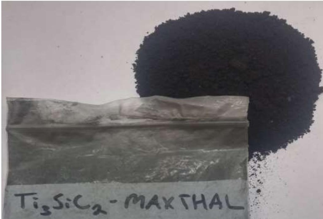
**Figure III. 2 :** *la poudre de la phase MAX  $Ti_3SiC_2$ .*
