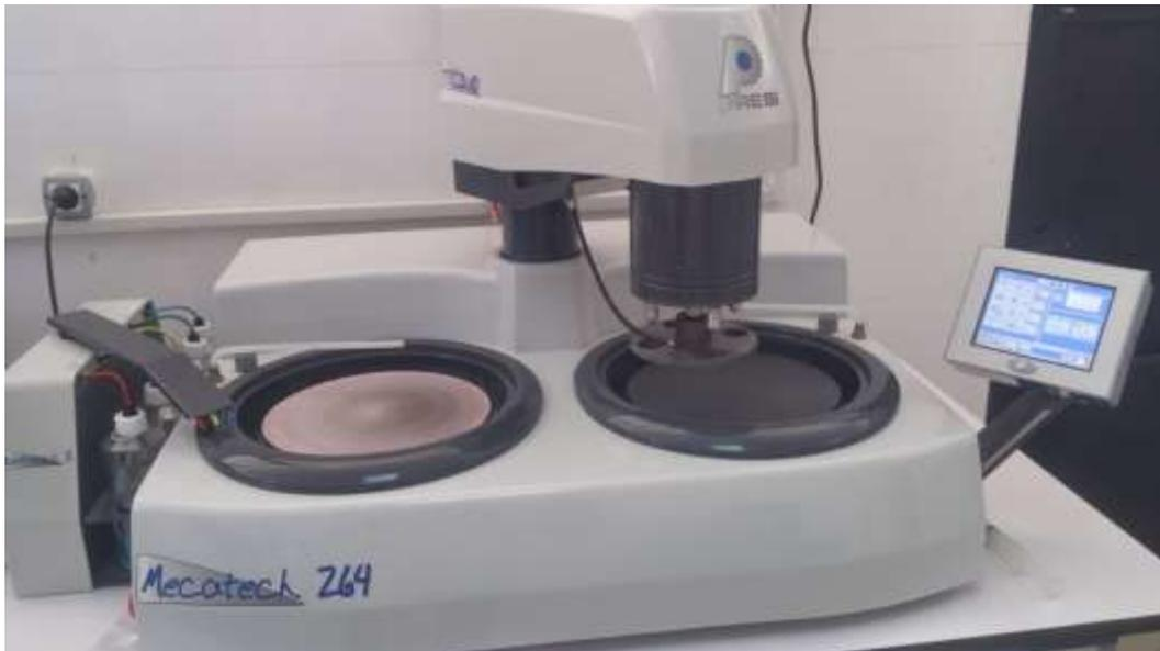
**Figure III. 15 :** *polisseuse automatique.*
