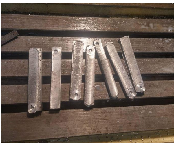
Figure.III.13 : découpage des échantillons de poudre Al_2O_3/ MoAlB .
