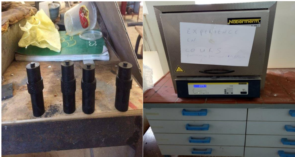
Figure III.2: Opération du traitement thermique des outils.
