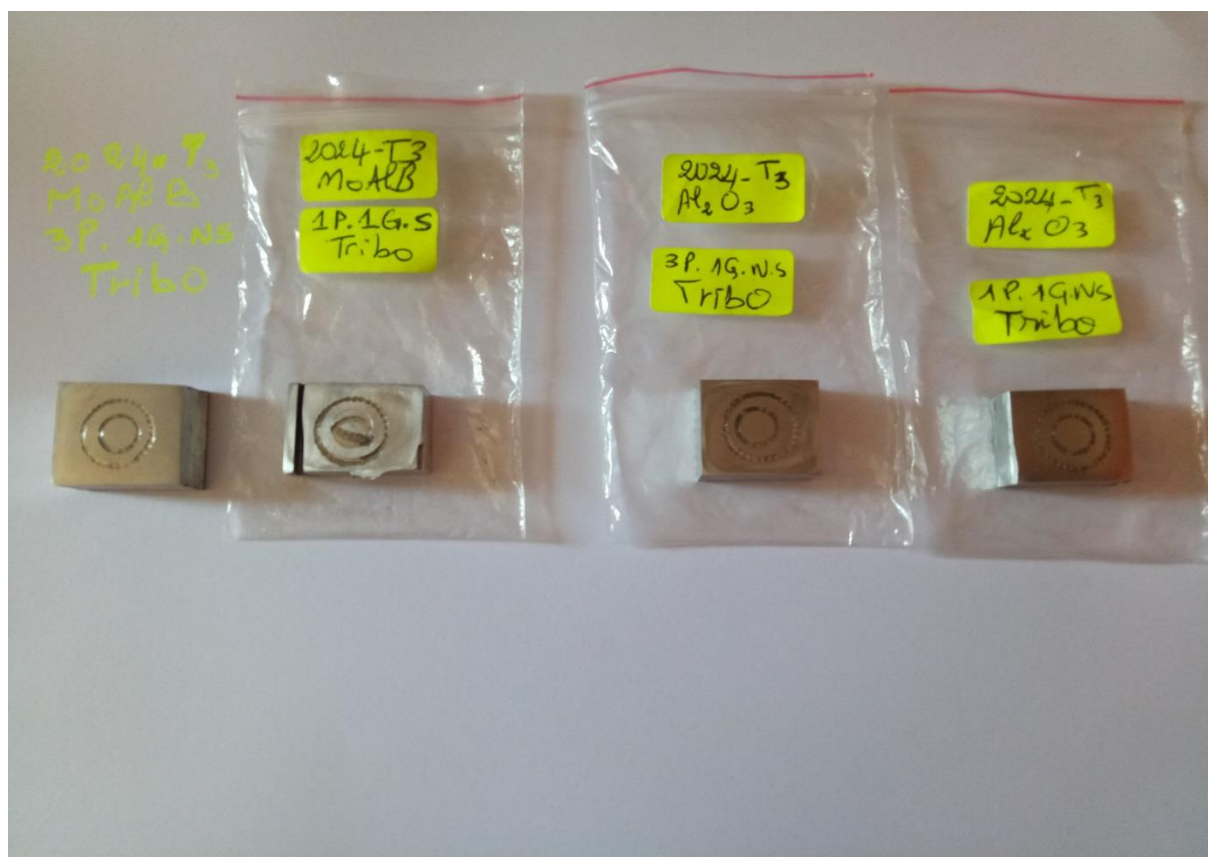
Figure III.19 : image des traces d'usure sur les échantillons 2024-T3 Al_2O_3 /2024-T3 MoAlB après passage au tribomètre.
