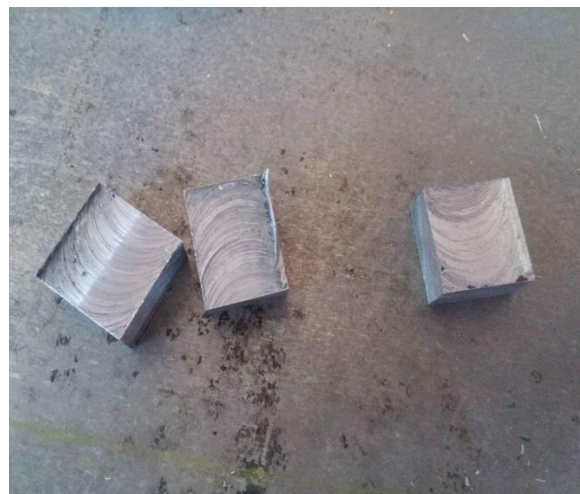
Figure.III.13 : découpage des échantillons de poudre Al_2O_3/ MoAlB .
