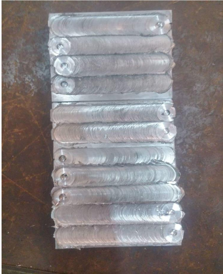
Figure.III.12. La tôle soudée en FSP.
