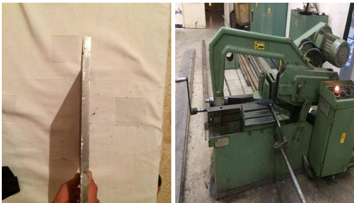
Figure.III.5 : découpage de la tôle.
