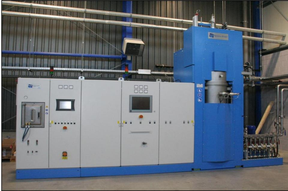
**Figure III.2 :** Machine SPS utilisée.
