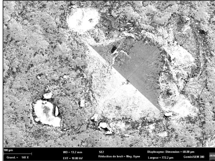
**Figure IV.14 :** Image MEB représente une empreinte micro dureté à 200N pour un échantillon fritté à 1425°C pendant 20 min.
