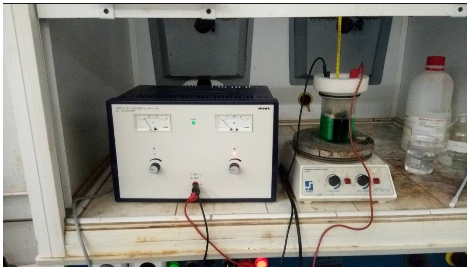
Fig. (III.6) : Schéma de montage d'électrodéposition
