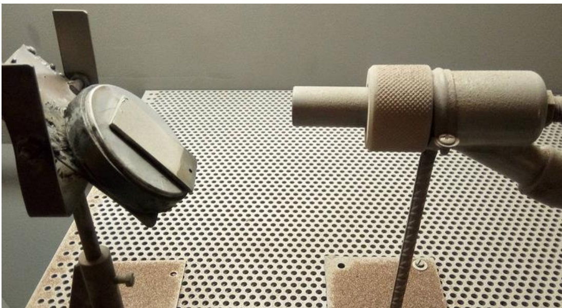
Figure (IV.8) distance entre la buse et le substrat
