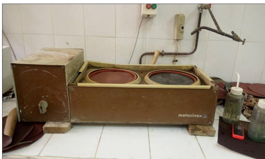
FigIII.3:Schéma de polisseuse utilisé dans le polissage mécanique
