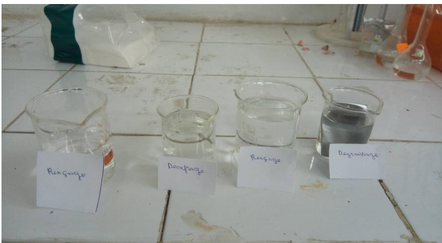
Fig(III.5) différent bain de préparation de surface
