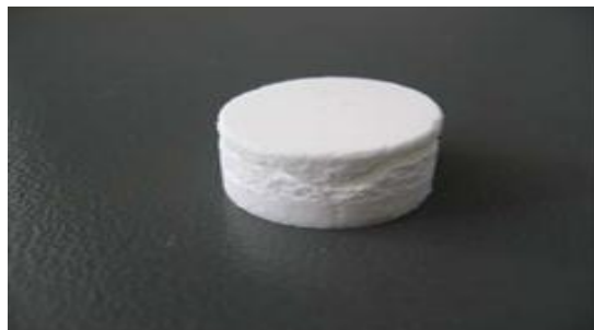
FIGURE 5: CLIVAGE D'UN COMPACT DE LACTOSE APRES EJECTION.
