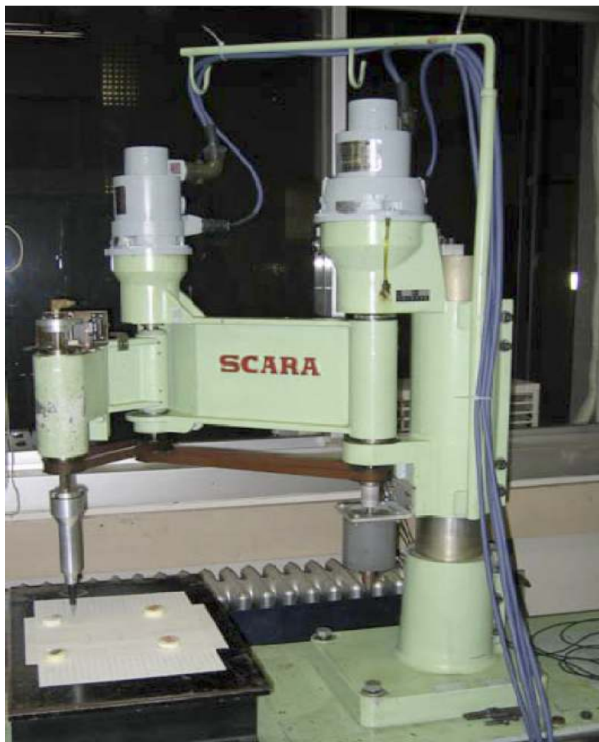
Figure 1.5 : le premier robot SCARA, fabriqué en 1980.
