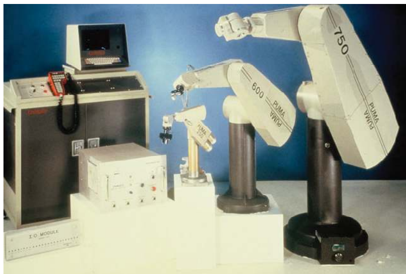
Figure 1.4 : Les trois premiers modèles du robot PUMA commercialisés par Unimation.
