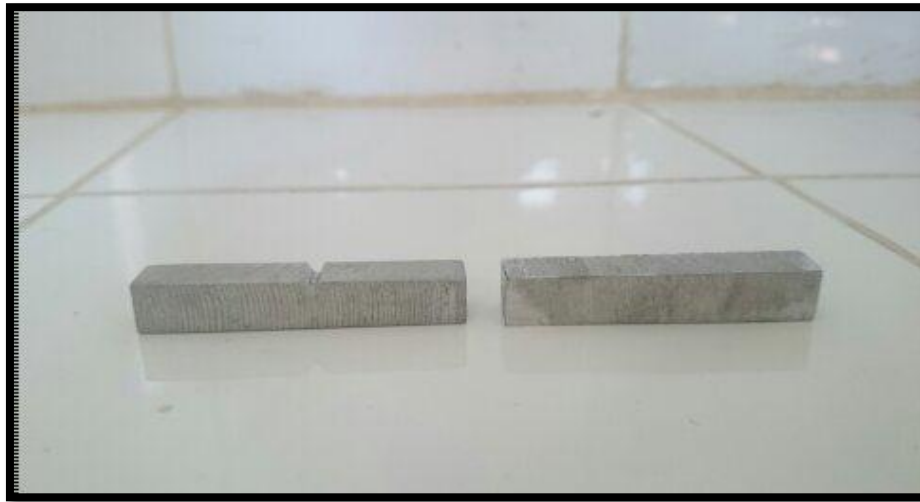
Fig.III.15 : Epreuve normalisée avec et sans entaille en forme V.
