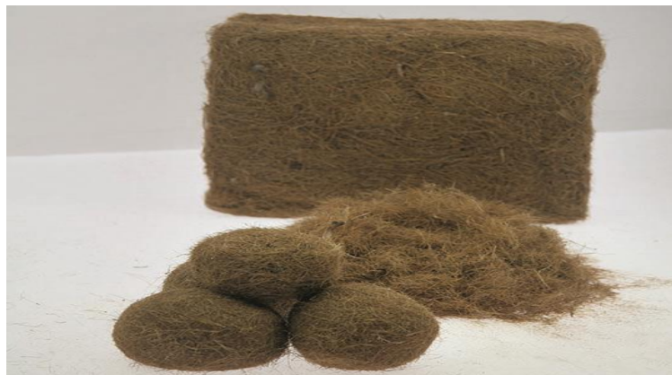
Figure 2.11 : matériau final (isolant à base d'algue marine)
