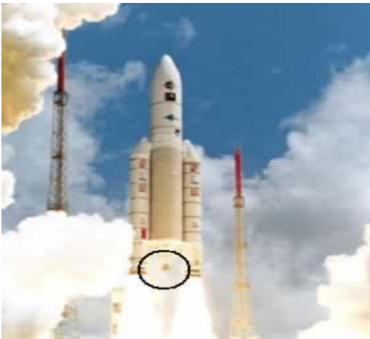
Figure I.17 : Tuyères d'une fusée
