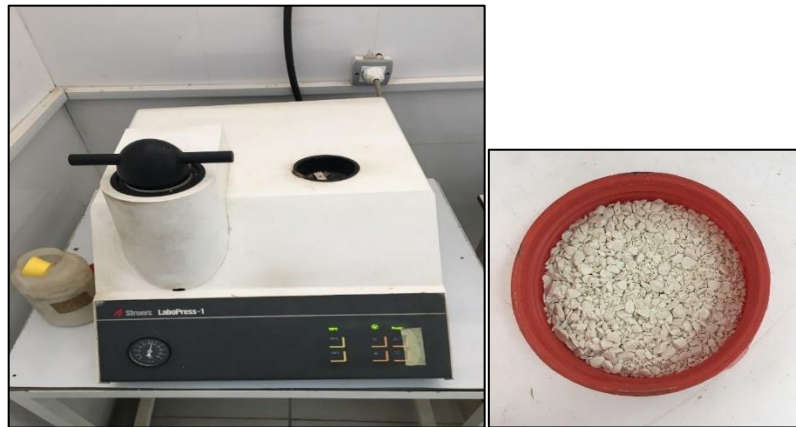
Figure 2.3 Enrobeuse A Chaud Struers Labo-Press-1 Et La Resine Utilisee
