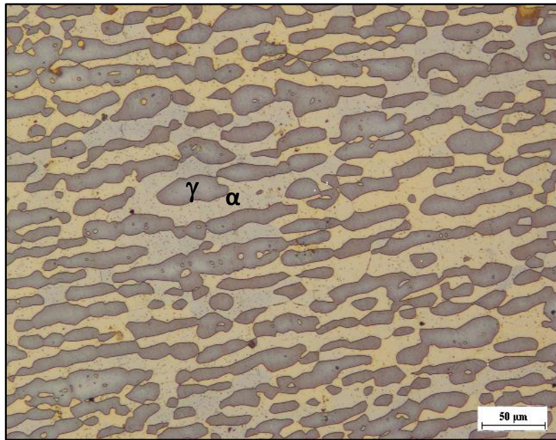
Figure 3.2 Microstructure après traitement de mise en solution (hypertrempe) (attaque électrolytique).
