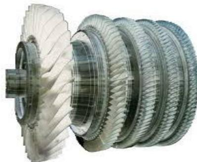
Figure 1.4: Compresseur axial [14]
