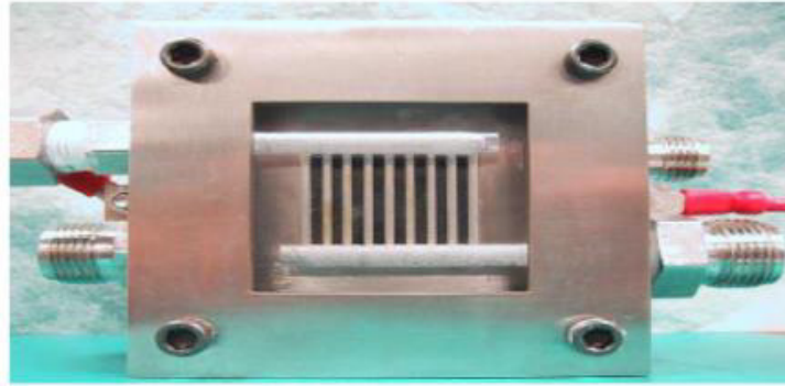
Figure 2. 4 : Photo d'un DMFC transparent, tiré de la référence [37].
