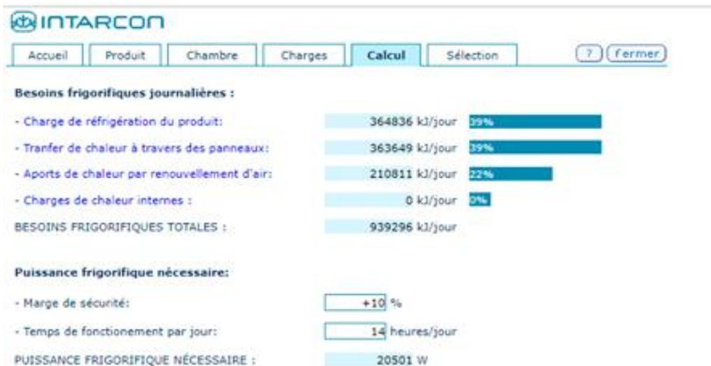
Figure III.5 : Résultats de la CF + calculés par le logiciel INTRACON
