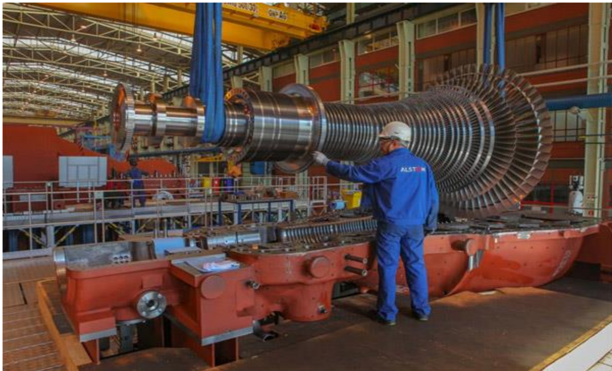
Figure 3-6 : Turbine à vapeur
