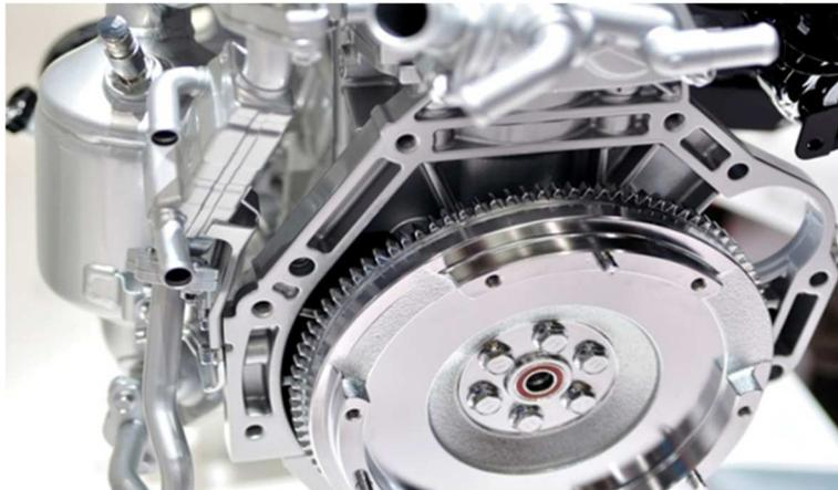
**Fig1.9** volant- moteur
