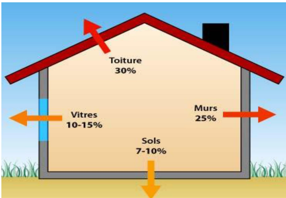
Figure 1-3: les déperditions thermiques d'une maison mal isolée
