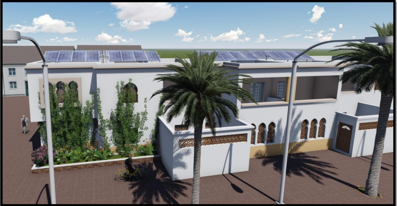
Figure 10.2 : intégration des panneaux photovoltaïques au niveau des toitures
