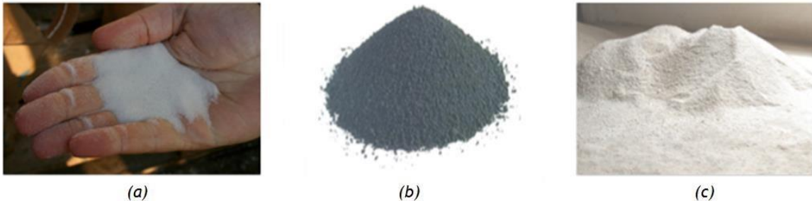
Figure 1.3. Exemples de charges utilisées dans les CMO : (a) : microbilles de verre, (b) : noir de carbone, (c) : silice
