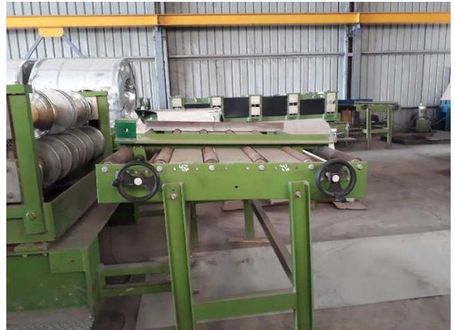
Figure I.12. Table de profilage
