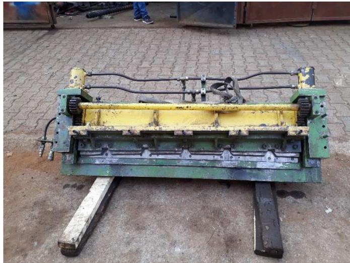
Figure II.6. Cisaille guillotine avant la modification
