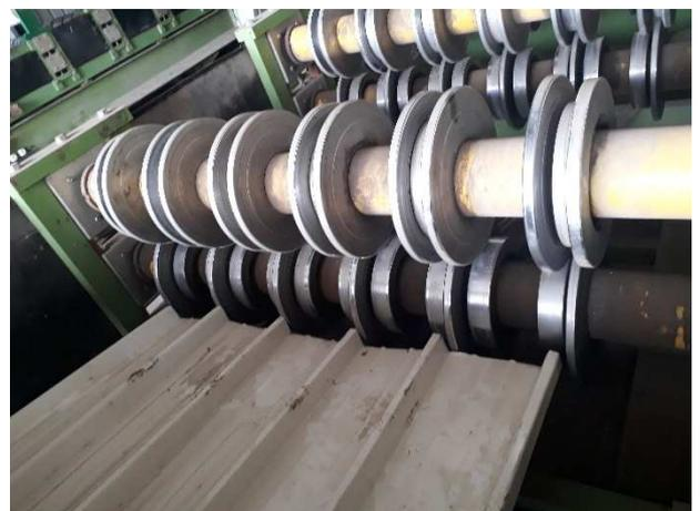
Figure I.13. Profilage de tôle
