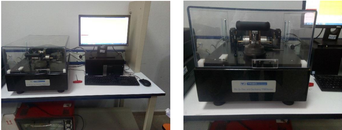
Figure III.10 : Tribomètre de marque TRIBOtechnic (Pin-On-Disc TRIBOtester) utilisée (CRTI).
