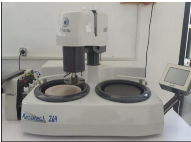
Figure III.2 Polisseuse utilisée lors de la préparation métallographique
