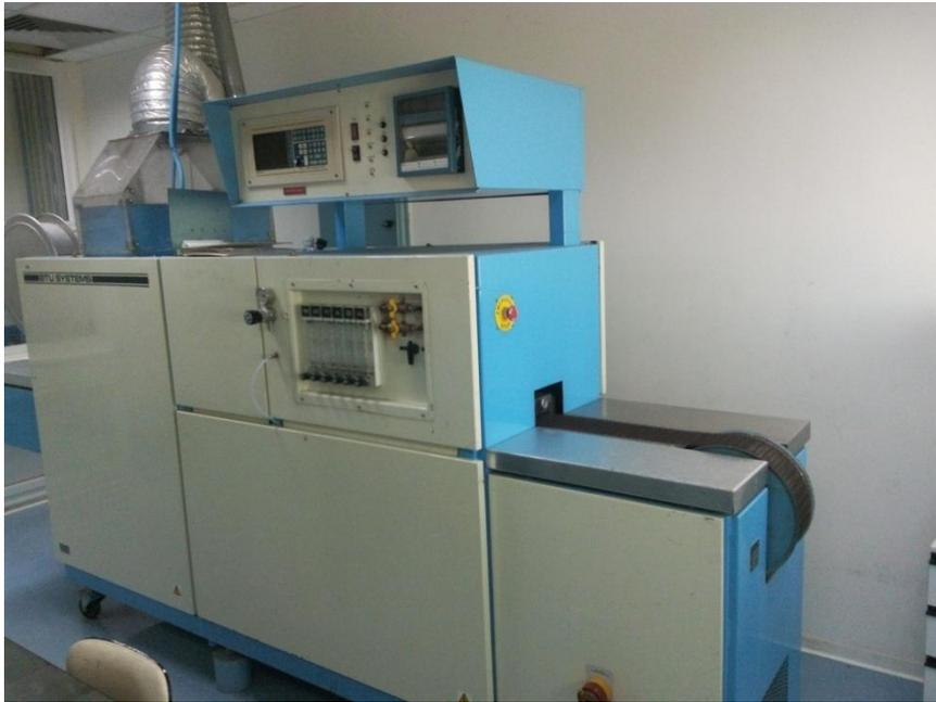
Fig.II.8 : Four de recuit thermique rapide (RTP) à tapis roulant.
