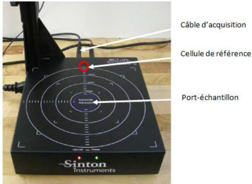
**Fig.3** : Port –échantillon de l’instrument QSSPC avec la fenêtre de la cellule référence et les câble d’acquisition du signal photogénéré.
