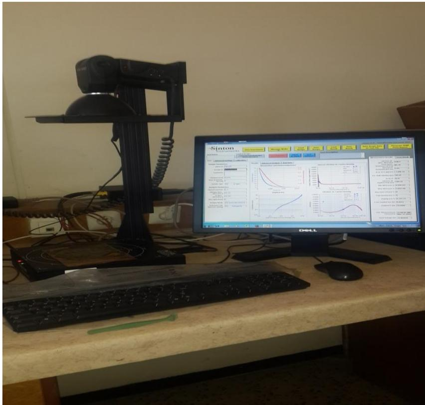
**Fig.1** : Photo du banc de la technique de mesure de la durée de vie effective  $\tau_{\text{eff}}$  QSSPC
