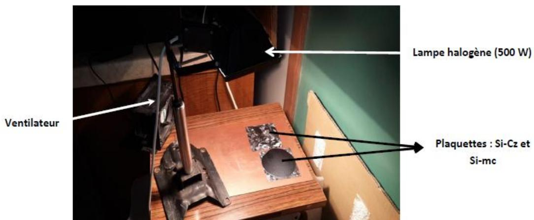
Fig.II.1: Photo du banc de dégradation LID par illumination de deux plaquettes de silicium Si-Cz et Si-mc.
