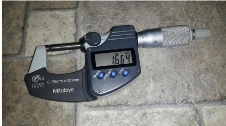
**Fig.7** : photo d'un palmer digital.
