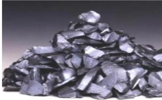
Fig. I.9 : Poly-silicium intrinsèque obtenu après distillation et purification.
