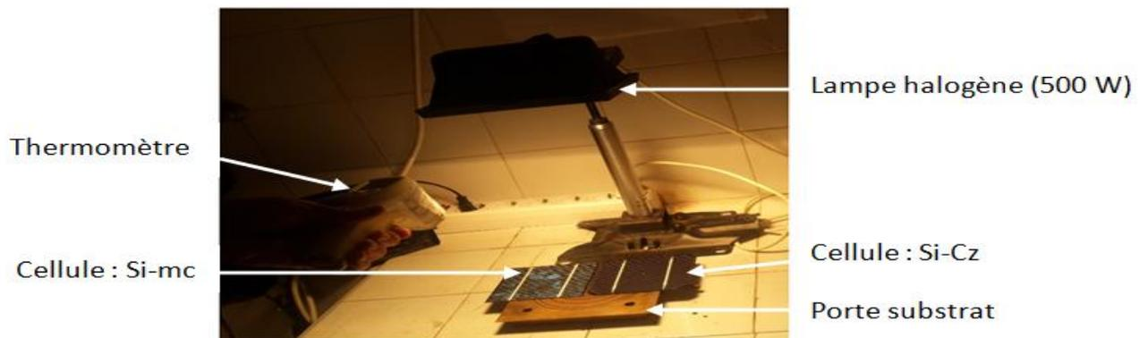
Fig.II.13: Photo du banc de dégradation LID par illumination de deux cellules de silicium Si-Cz et Si-mc.
