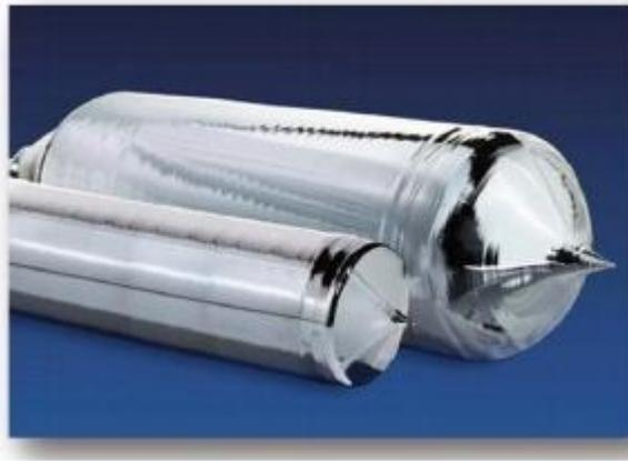
Fig. I.11 : lingots de silicium cristallin élaborés par la technique Czochralski.
