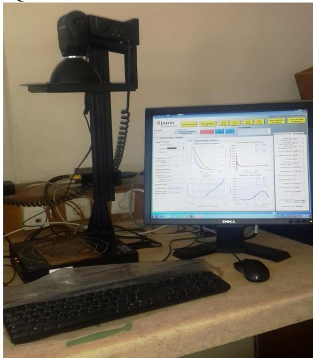
Fig.II.2: Banc de mesure de la durée de vie effective par la technique QSSPC.
