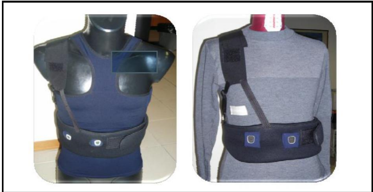
Figure 1.5 : Prototype ProeTEX 3 de tee-shirt. A gauche le tee-shirt de la sécurité civile, conçu en fibres Synthétiques élastiques. A droite, le tee-shirt des pompiers, confectionné en coton. Seule la partie intégrant les électrodes est élastique pour améliorer les contacts entrés électrodes et la peau [10].
