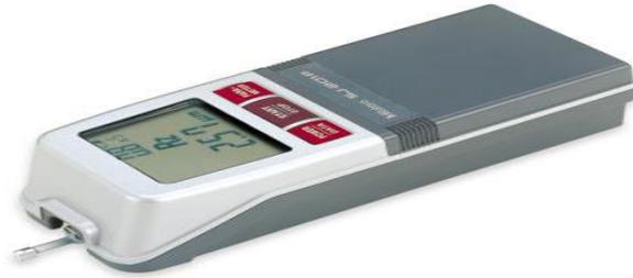
Figure II.2 :rugosimètre.
