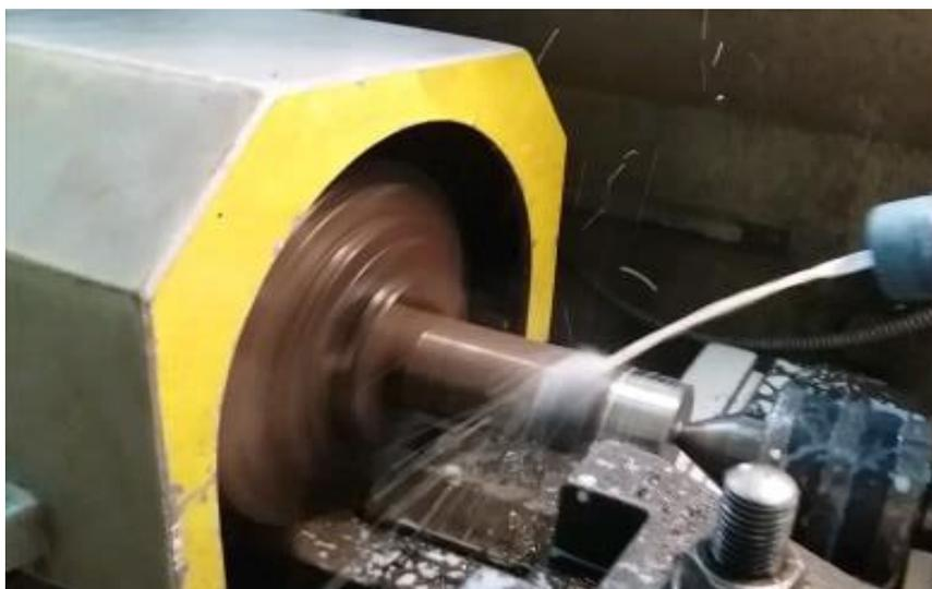
**Figure II.10 : la lubrification.**
