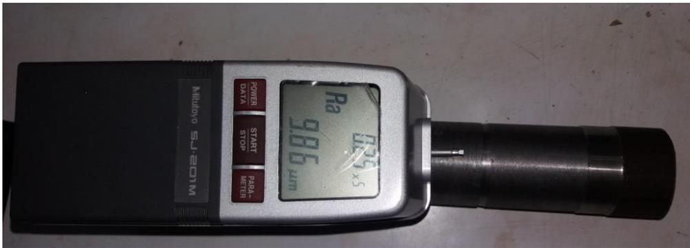
Figure III.6 : rugosimètre.
