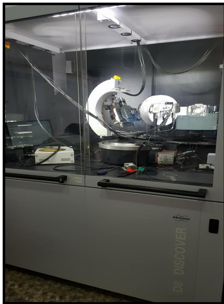
Figure 3.6 : Diffractomètre Bruker D8 Discover utilisé
