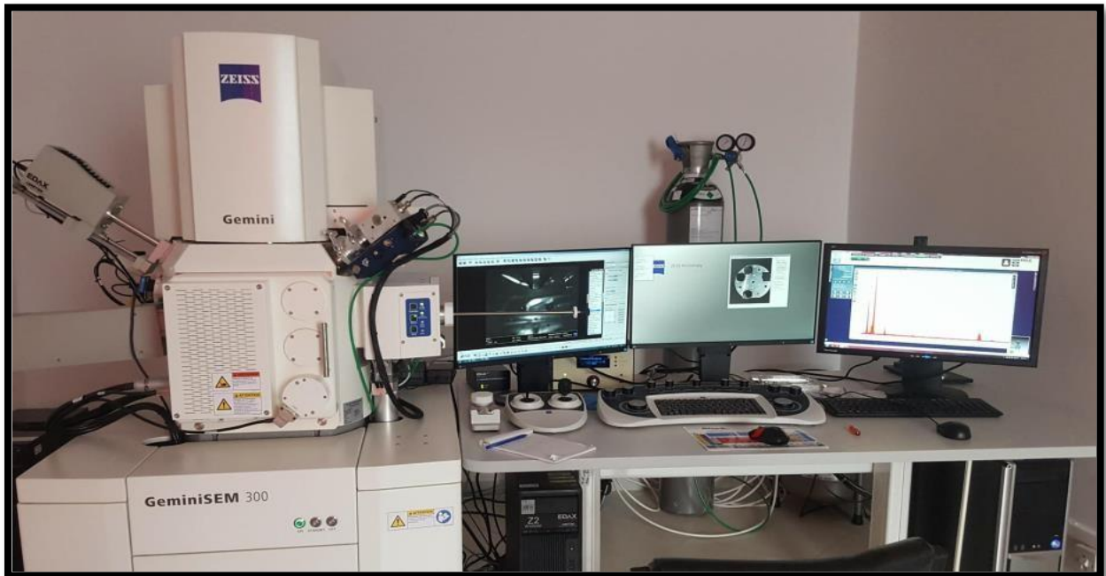
Figure 3 .11 : balayage utilisé (Gemini SEM 300)
