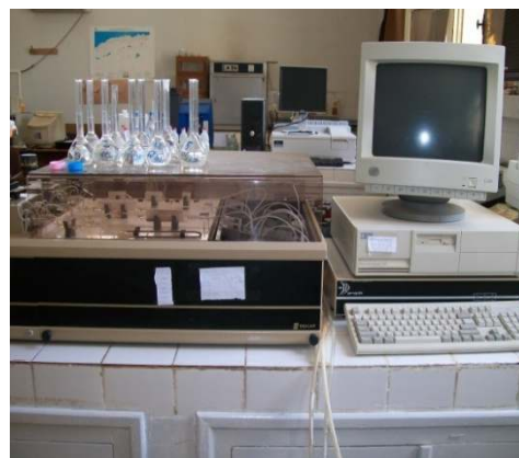
Figure .4. Analyseur a flux continu pour le dosage des cations.
