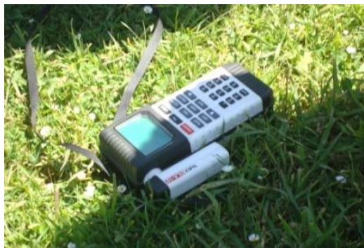
Figure III.2. Appareil GPS utilisé (marque MAGELLAN).
