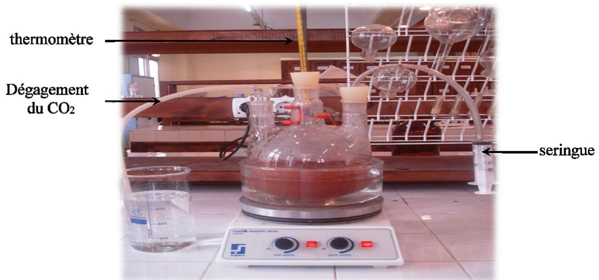
Figure III.3 : Dispositif de la fermentation alcoolique
