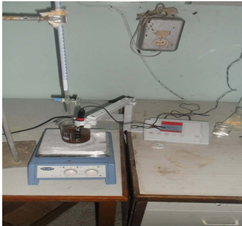
Figure.7. montage de la zetametrie.
