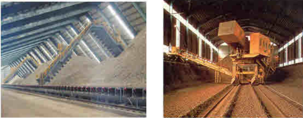
Figure I.4 Préhomogénéisation des matières premières [2]
