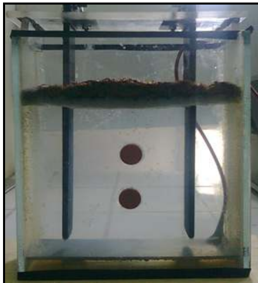
Figure 4.11 : Solution clarifiée après traitement d'EC/EF
