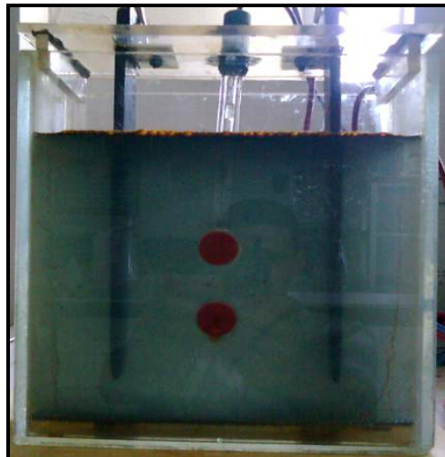
Figure 4.9 : Solution pendant le traitement d'EC/EF, avec apparition de couleur verte.
