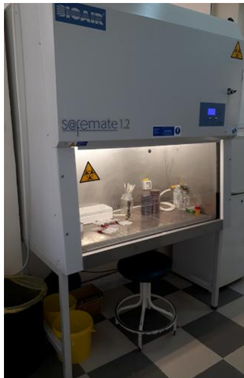
Figure 3. Poste de sécurité microbienne classe II (Originale).
