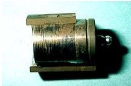
Figure I.7 : Corrosion avec frottement
