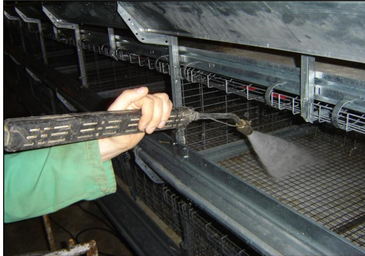
Figure 47: Nettoyage du tapis de fientes par l'utilisation de l'eau chaude (Photo personnelle)
